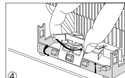
取り付け金具の切り欠き部分をブラケットの両方の突起に取り付けます。取り付け金具についてるレバーを図のように指で握り回しますと切り欠き部分が上方に移動しクーラー本体を固定します。
