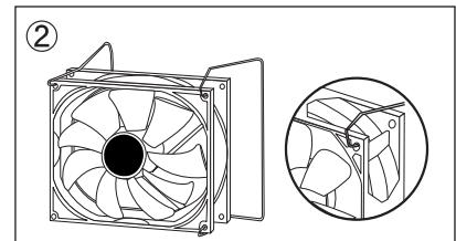
120mmクーラーファンに、付属の装着用クリップの先端部分をクーラーファンのネジ穴部分に抜けないようにしっかりと挿し込んで下さい。
