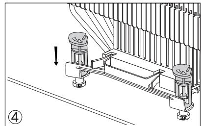
CPUソケットの周囲にある4つの穴に、取り付け金具のアンカーの半透明部分を差し込んだ後、アンカーの黒い部分を下にカチリとなるまで押して下さい。取り付けの際、アンカーパーでマザーボードを傷つけないようお気を付け下さい。
