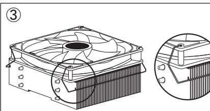
装着用クリップの留め具部分を本体の切り込み部分に掛けてクーラーファンをしっかりと固定して下さい。留め具部分が切り込み部分にしっかりと固定されていませんとクーラーファンが外れる可能性があります。※Oでも取り付け可能ですが、◎の取り付け方法の方がより高い冷却性能を発揮いたします。
